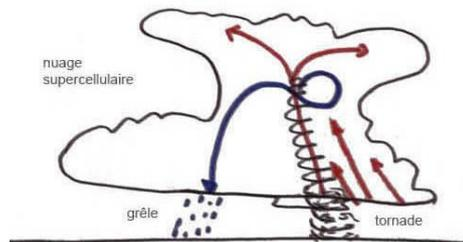
Dans ce cas là (cf. schéma ci-contre), les poussées d'air chaud sont plus fortes que les descentes d'air froid. Un courant circulaire se crée et provoque une alimentation permanente et les vents intérieurs peuvent atteindre les 140km/h. On assiste alors à une séparation entre le courant ascendant et le courant descendant. Les tornades peuvent alors se créer en début de nuage. C'est aussi pour ce type d'orage que les grêlons sont les plus gros.
